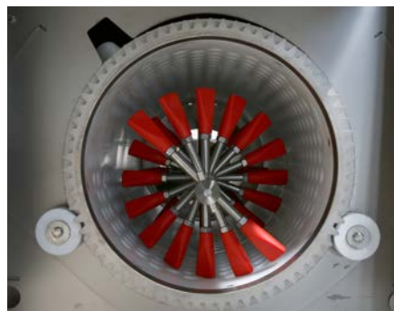
Albero diraspatore. Destemmer shaft.
