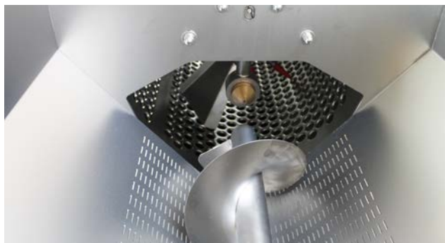
Tramoggia drenante. Draining hopper.
