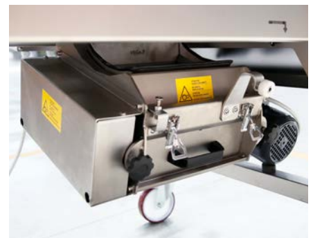
Pigiatrice estraibile con sgancio. Removable crusher by release.
