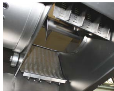
Sistema di diraspatura parziale. Partial destemming system.
