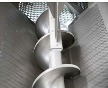
Tramoggia drenante. Draining hopper.
